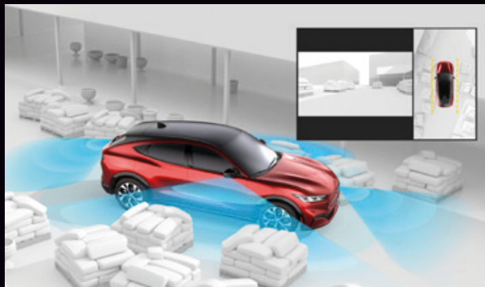
SYSTEM KAMER 360 STOPNI
